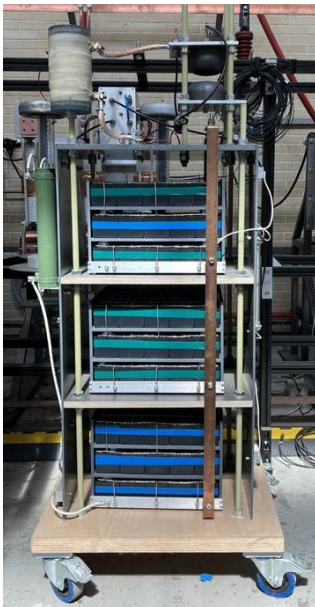
Abbildung 1: Bestehender Kommutierungspfad des DC-Versuchsstands mit Kondensatorbatterie, Spule und Koppelfunkenstrecke
